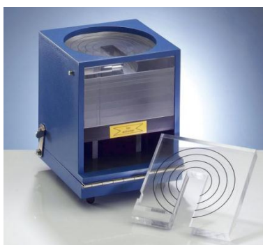
Obrázek 9: Fantom pro měření dávek pro rentgenové svazky nízkých energií
