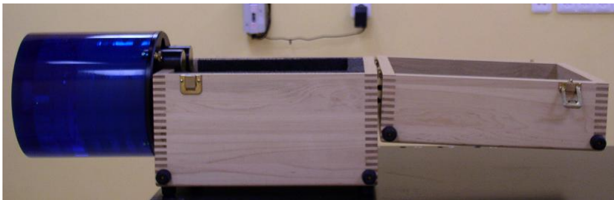
Obr. 11: Fantom pro kontrolu CBCT kvality obrazu Catphan
