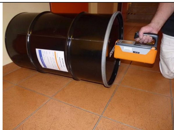
Obr. 8 Geometrie měření válce s čelem detektoru směrem k válci
