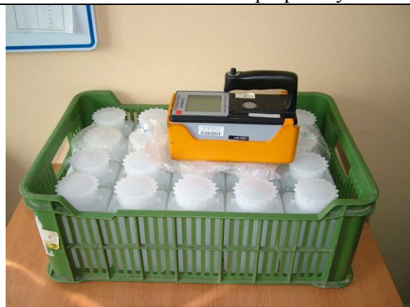
Obr. 7 Geometrie měření přepravky shora
