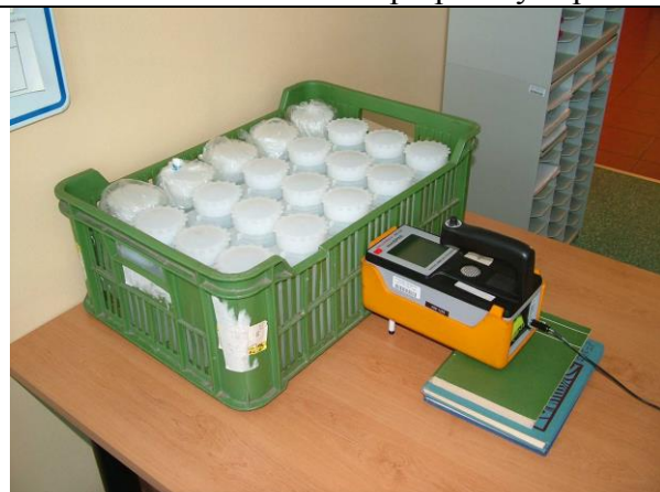
Obr. 6 Geometrie měření přepravky zepředu
