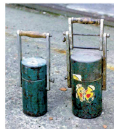
Olověný přepravní kontejner Vysoká hmotnost – různé druhy RA látek
