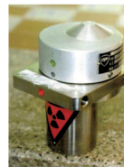
Popeloměr (obsahuje dva ZIZ – ^{241}\text{Am} , ^{137}\text{Cs} )
