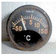
Stupnice - luminiscenční barva obsahující ^{226}\text{Ra} a ^{90}\text{Sr}
