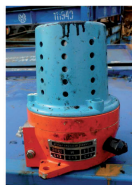
Průmyslový typ kouřového detektoru ( ^{241}\text{Am} )
