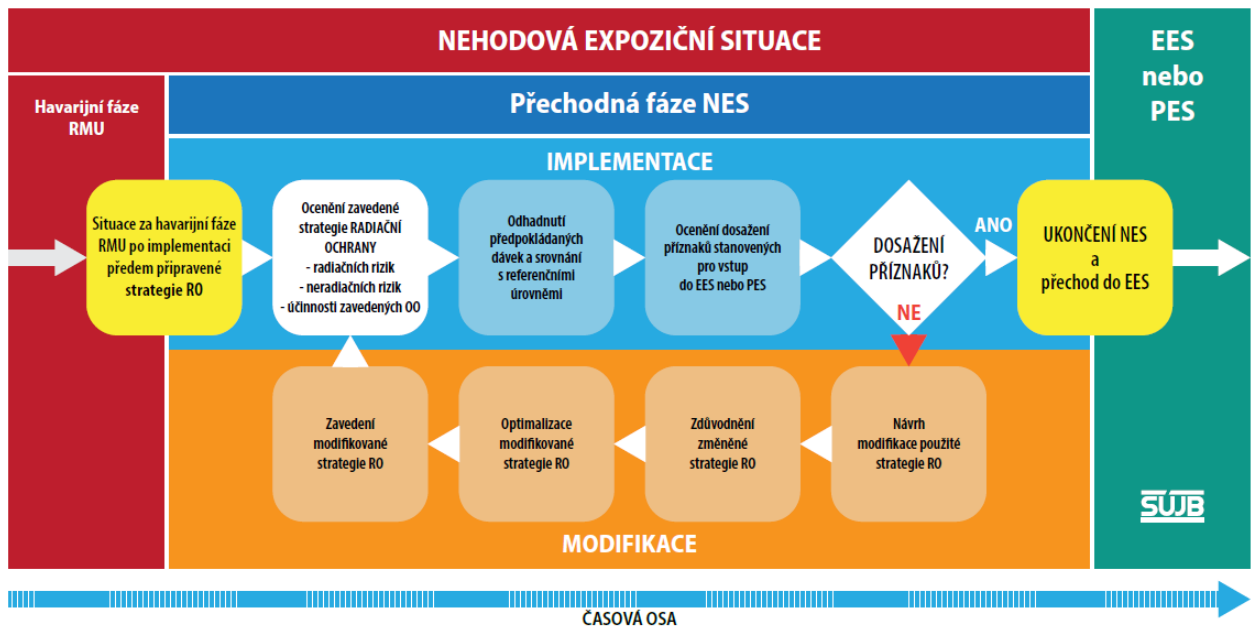
Obr. 11 Schéma procesu optimalizace strategie radiační ochrany v přechodné fázi nehodové expoziční situace (NES)
